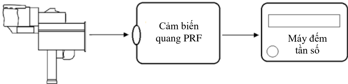
Hình 1. Sơ đồ kiểm tra sai số tần số lặp lại PRF
